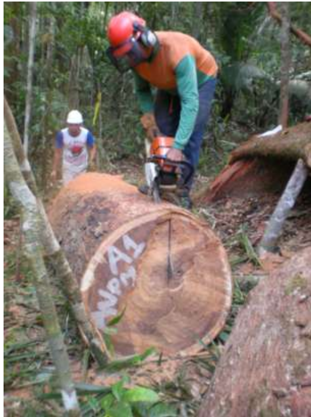
Figura 4 – Corte da tora ao meio
