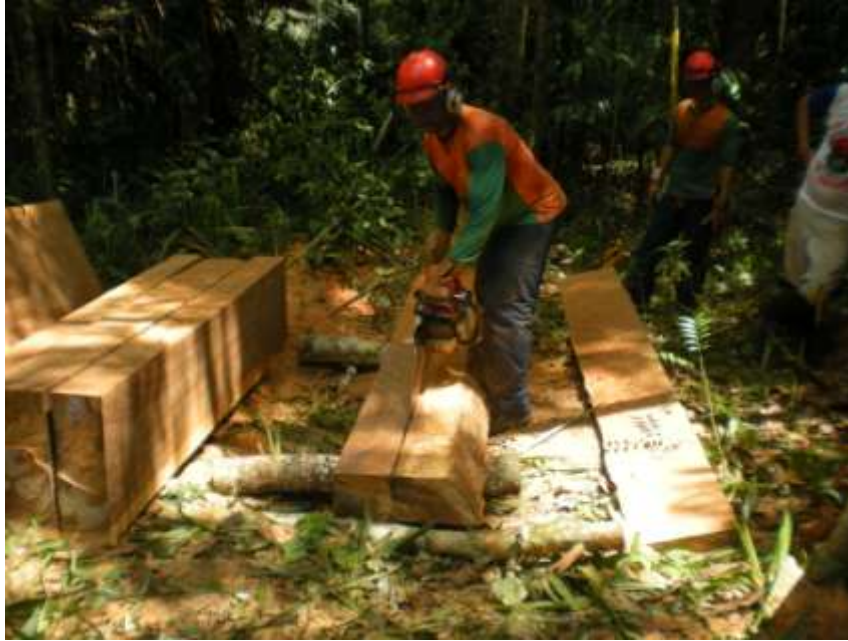
Figura 8 – Corte vigas de 17x17x50cm
